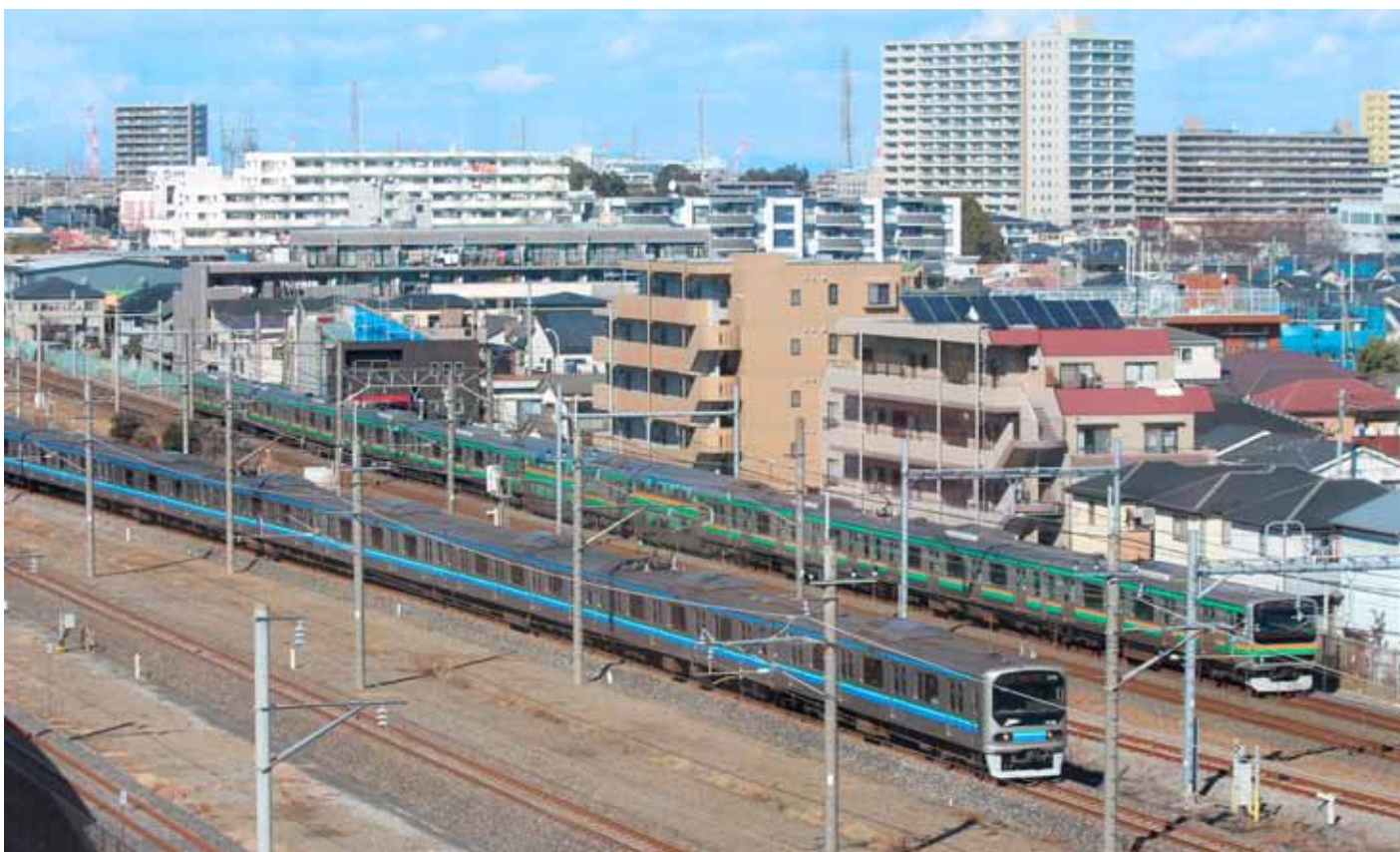
Modernia kapearaidetekniikkaa Omiyassa Japanissa. Japanin rautateiden pääraideleveys on yhä 1067 mm. Kuva Markku Nummelin.
