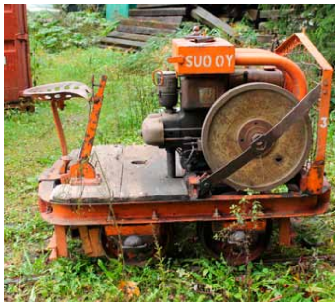
Turvesuolla aikanaan käytetty Schienen-Kuli-veturi. Raideleveys on 600 mm. Kuva Kalle Renfeldt.
