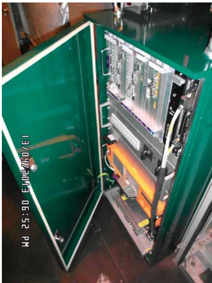
Pack`11 ETCS+STM2N -laitteisto Sr2-veturiin sovitettuna. Kuva: Jouni Lehmusto
