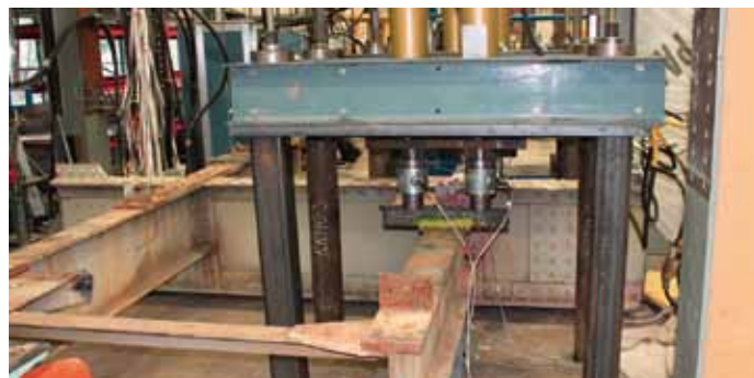
Kuva 3. Kruunukylänjoen ratasillan sekundääripalkiston koekuormitus Rakennustekniikan laitoksen koehallissa.
