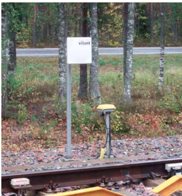
Kuva 1. RFID-lukijan antenni mittauspisteessä. Kuva: Seppo Mäkitupa
