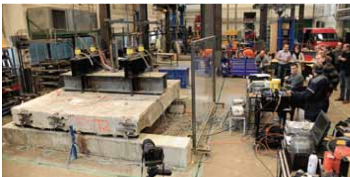
Kuva 1. Suokannan ratasillan toisen lohkon koekuormitus Rakennustekniikan laitoksen koehallissa.
