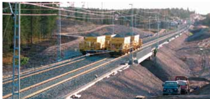
Kuva 2. Tekemäjärvenojan ratasillan koekuormitus Orimattilassa ennen oikoradan avaamista.
