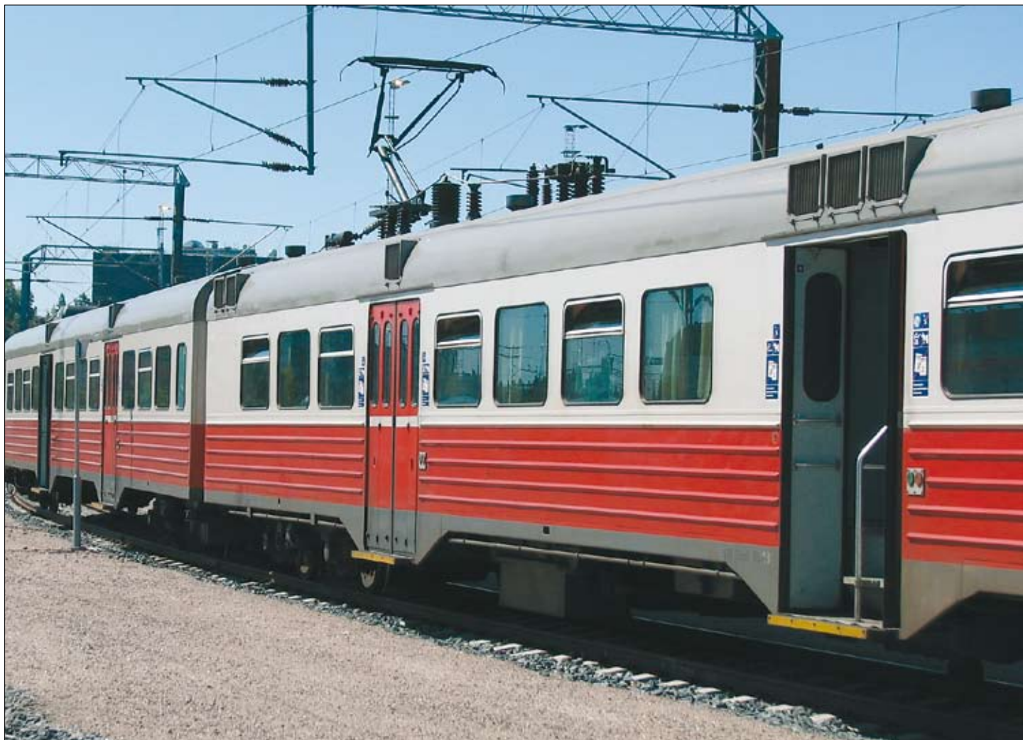
Sm1-junan erottaa Sm2-junasta sen sivulla kulkevista neljästä vaakasuorasta vahvikkeesta.
