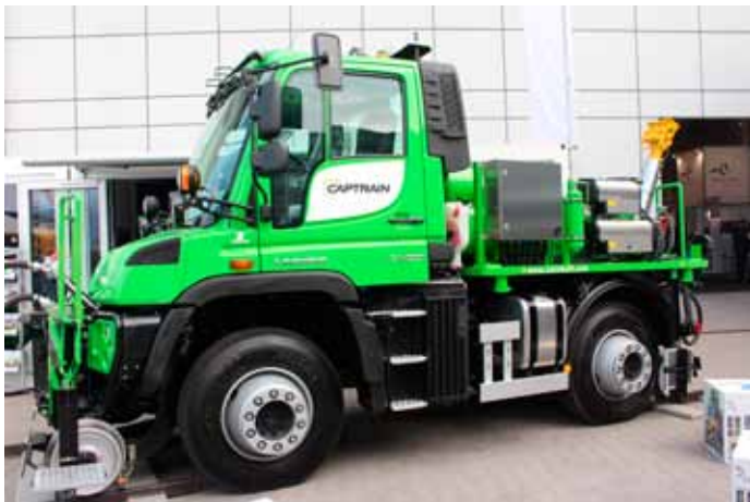
Zwiehoffin Unimog 1100 tonnin vaihtotyökuormalle, oma paino on 13 tonnia. Koneita voidaan käyttää eri varustuksilla mm. vaihtotöihin, lumenlinkoukseen, lumenauraukseen, kasvillisuuden poistoon ja nostotöihin. Kuva Markku Nummelin.
