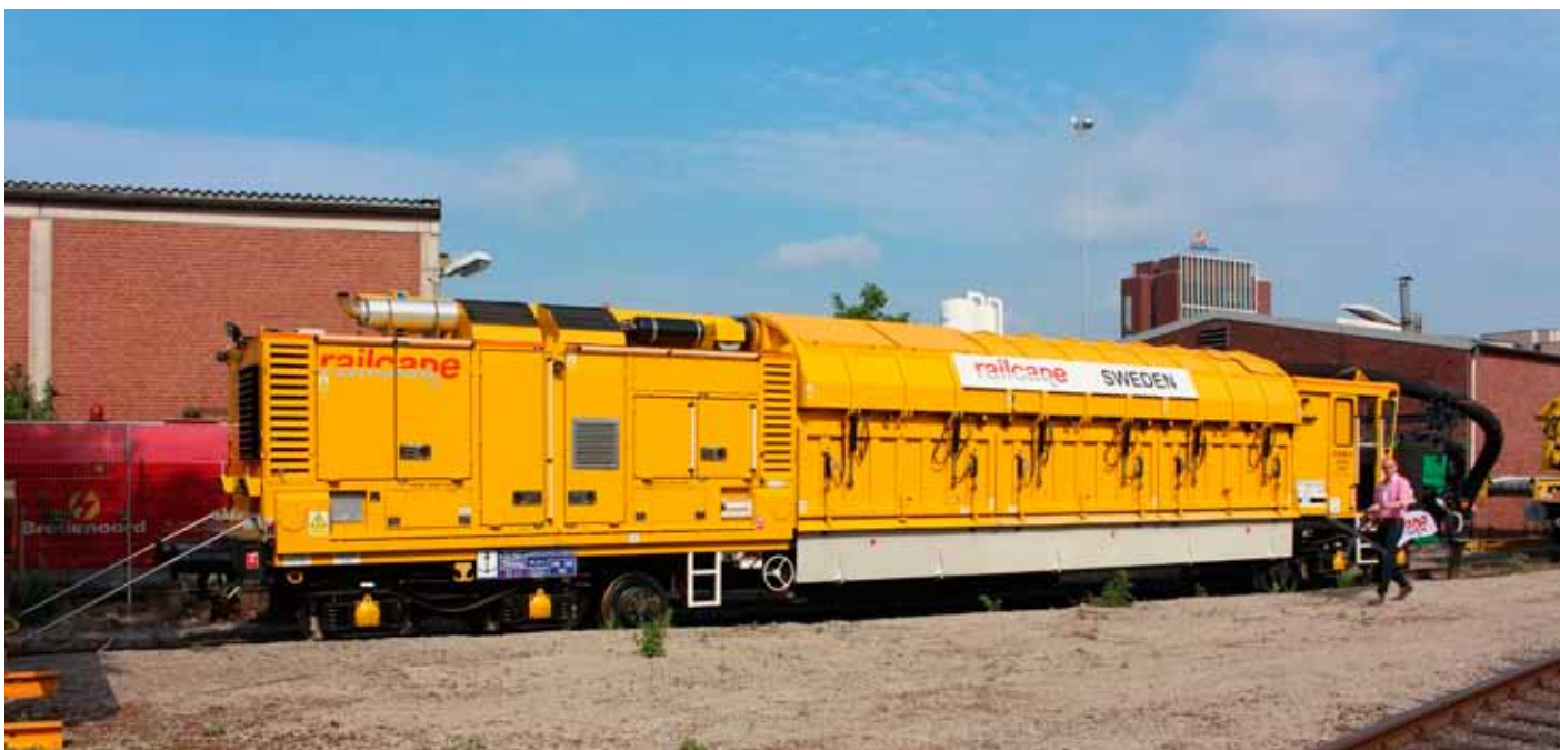
Railcaren Railvac 16000-sepeli-imuri. Konetyyppiä voidaan käyttää mm. vaihteiden ja tasoristeysten tukikerroksen puhdistukseen, kaapelien esiinottoon ja töihin matkustajalaitureiden kupeessa ja tunneleissa. Kuva Markku Nummelin.
