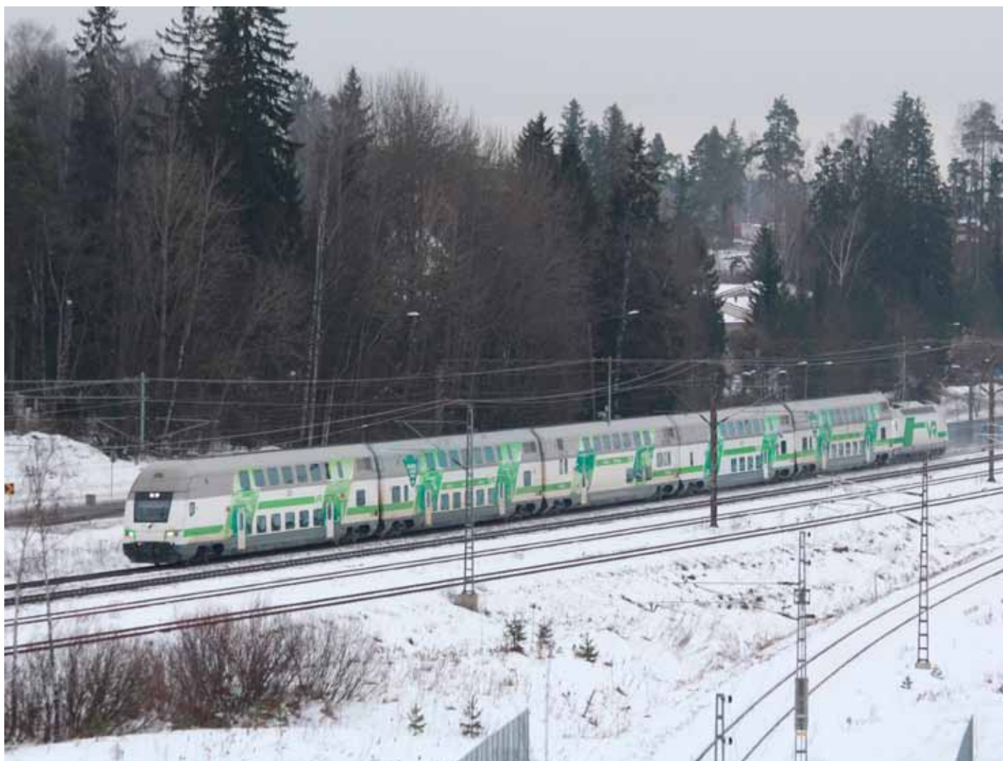
Sr2-työntää pääradalla IC-junaa. Kärjessä on Edo-ohjausvaunu. Kuva Markku Nummelin.
