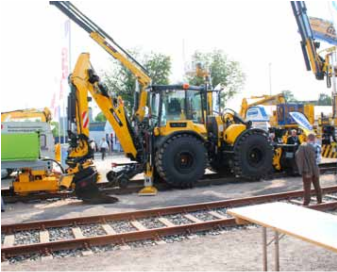
Tiellä ja raiteilla kulkeva runko-ohjattu Huddig-traktorikaivinkone, missä on lisänä kappaletavaranoosturi. Kone on erityisesti varustettu rautatiekäyttöön. Koneen kaivuupuumin päässä on Engconin proportionaalisesti ohjattu rototiltti tartuntakouralla. Kuva Kalle Renfeldt.
