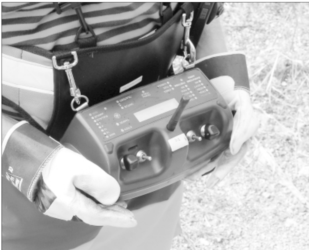
Kauko-ohjauslähetin muistuttaa kauko-ohjattavien leikkijunien ohjainta, mutta siinä huomattavasti enemmän toimintoja.
