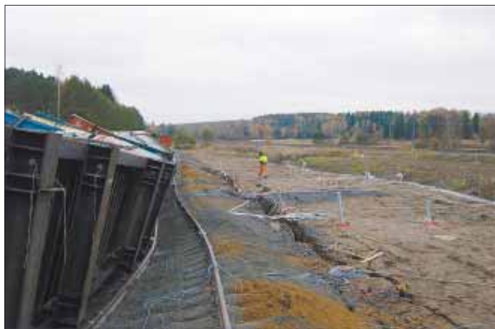
Kuva 3. Sortuman tapahtuttua sivuttaissiirtymät olivat noin metrin. Kaikki mittalaitteet olivat virheettömässä kunnossa myös tämän jälkeen. Onneksi kyseessä oli kuitenkin ainoastaan koejärjestely.
