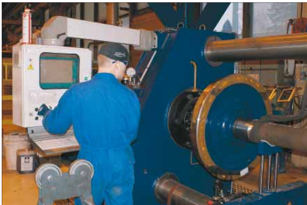
Asentaja näkee suoraan näytön grafiikasta, onko pyörän puristusvoima sallitun minimi ja maksimivoiman välissä suhteessa puristusmatkaan. Näytöstä voi seurata myös käytettyä maksimivoimaa. Mittaustiedot tallentuvat myös tietojärjestelmään.
