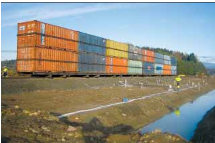
Kuva 2. Sorrutuskoe kesti noin vuorokauden, jonka aikana kuvassa näkyviin vaunuihin lastattiin huomattava ylipaino. Kaikki mittalaitteet havaitsivat siirtymiä jo ennen varsinaista sortumaa. Normaaliolanteessa hälytysjärjestelmä varoittaa heti, kun liikettä alkaa tapahtua, jolloin saadaan riittävästi aikaa turvallisuuden varmistamiseen.
