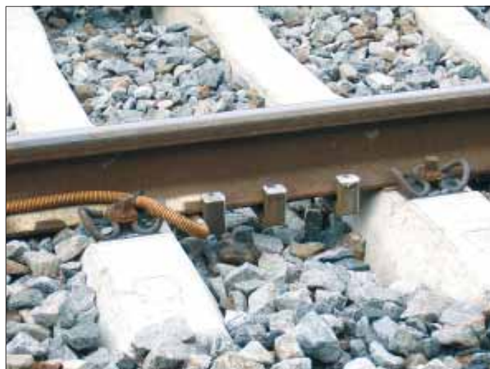
Kuva 2. Optinen pyörävoima-anturi, ProRail.
