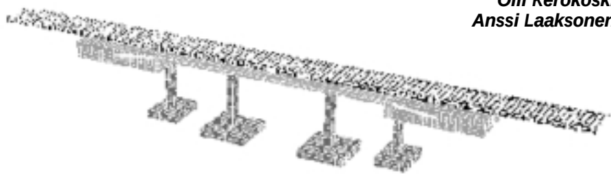
Silta-analyysissä käytetty laskentamalli (numeerinen elementtimenetelmä).
