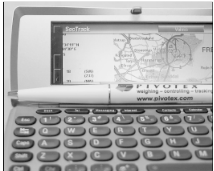
Banedanmarkin ratatyökoneen paikka haettuna kännykkään PivoTrack-järjestelmän SecTrack-palvelun avulla
