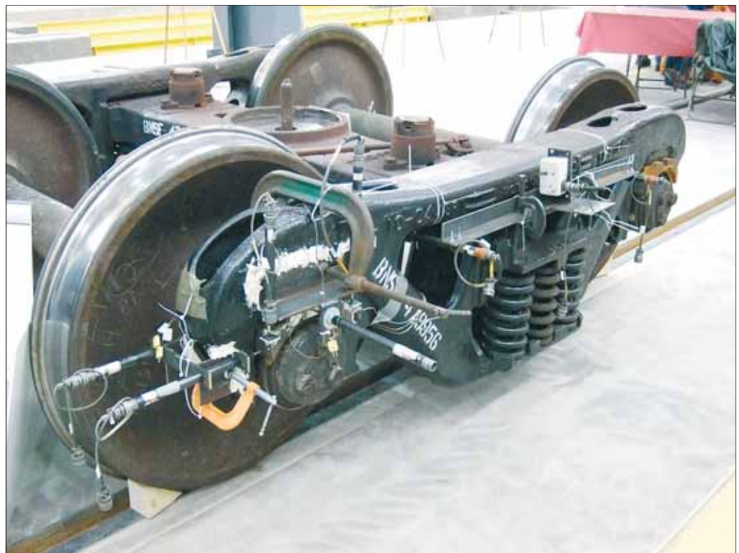
Kalustoyksikön pyöräkerrat instrumentoidaan mittauksia varten
