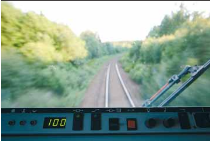
Ansaldo JKV-laite on vakiovaruste ruotsalaisissa vetureissa...
