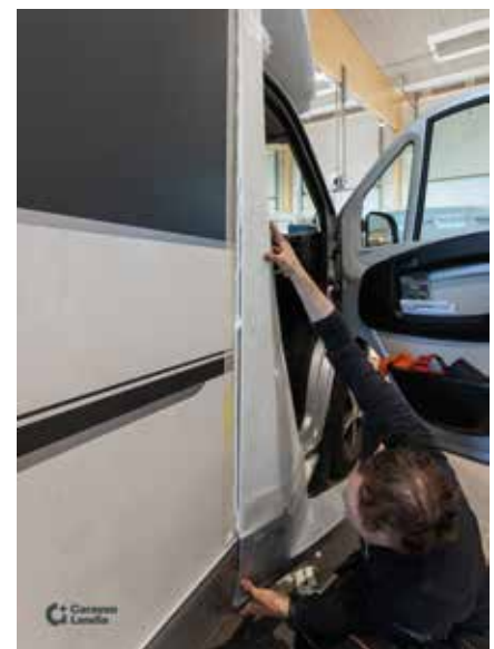
Asentaja Kim Koskinen kiinnittämässä uutta kulmapalaa paikoilleen.
