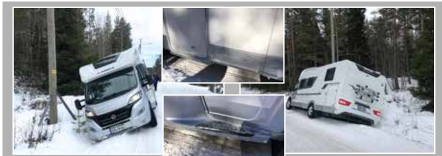
Tästä tilanteesta lähdettiin liikkeelle: ojan penkassa ollut kivi repi kyljen muoviosia, astinlautaa ja ovenkarmia. Myös kaksi vannetta vaurioitui.
