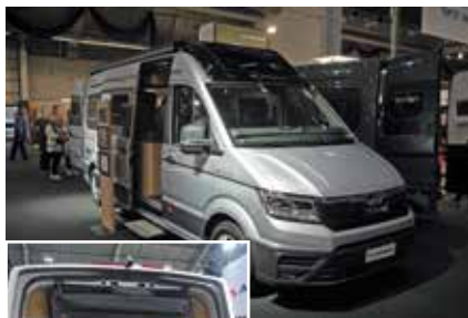
Adria esitteli uuden MAN -alustaisen retkeilyautomallinsa Adria Twin 680 . Takasänky saadaan sähköisesti nostettua ylös isompien tavaroiden kuljetusta varten.
