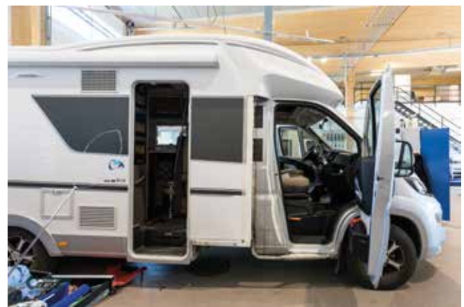
Korjaustyö alkoi rikkoutuneiden osien irrottamisella liimauksistaan. Tehtailla käytetään todella reilusti liimoja.
