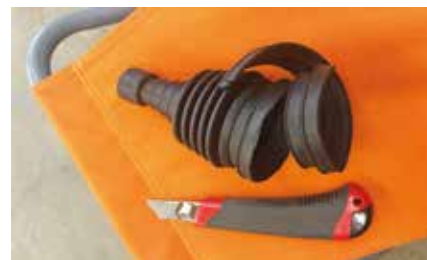
Mattopuukolla kaksi resorikierrosta pois ja suojakumi oli sopiva umpioon.
