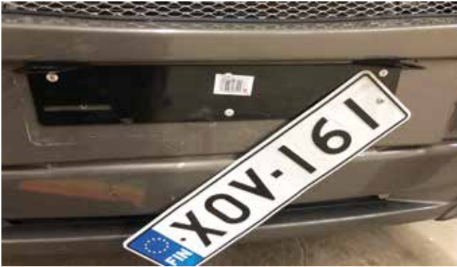
Paneelin teline ruuvataan kiinni rekisterikilven taakse.
