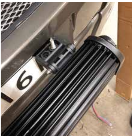
Paneelin jalat kiinnitetään rekisterikilpitelineeseen.
