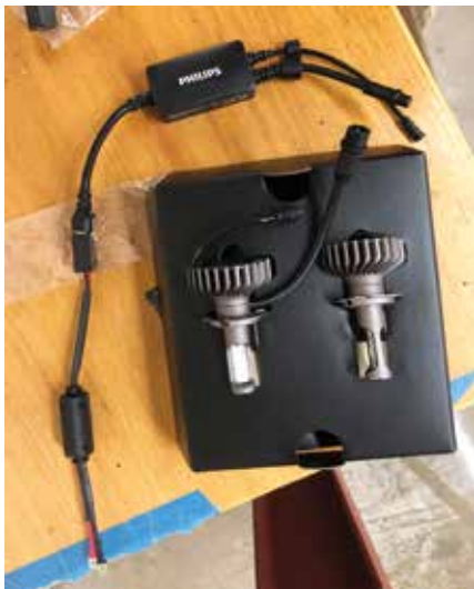
Tästä lähdettiin liikkeelle. Kuvassa molemmat LED-polttimot ja muuntajaosa toiseen.
