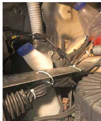
Vasemmassa alareunassa resorikumien sisällä uusi LED-polttime ja kumihanskassa muuntajaosa.
