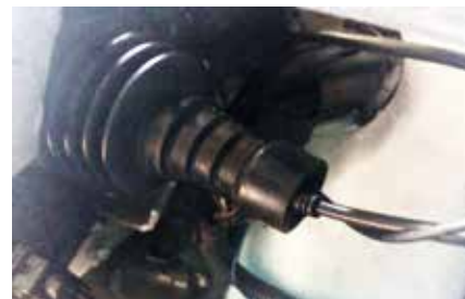
Resorikumi tiiviisti kiinni umpiossa. Uusi LED-polttime resorin sisällä.
