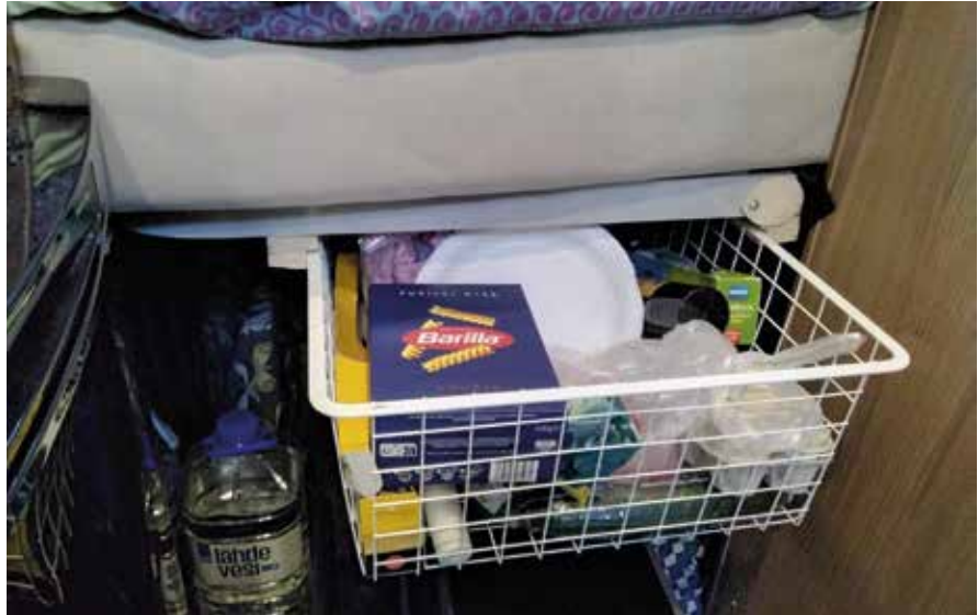
Takaosan parisängyn alle Seppo on rakentanut vedettävät lankakorit pikkutavaroille. Liukukiskot on tehty puulistoista. Koreja on yhdistetty narulla kaksi peräkkäin.
