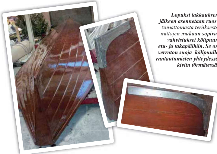
Kirkkoveneen täyskunnostukseen käytettiin useita kymmeniä työtunteja. Ensin perusteellinen hionta ja puhdistus ja rakenteiden paikkailu ja sitten lakkaus.
