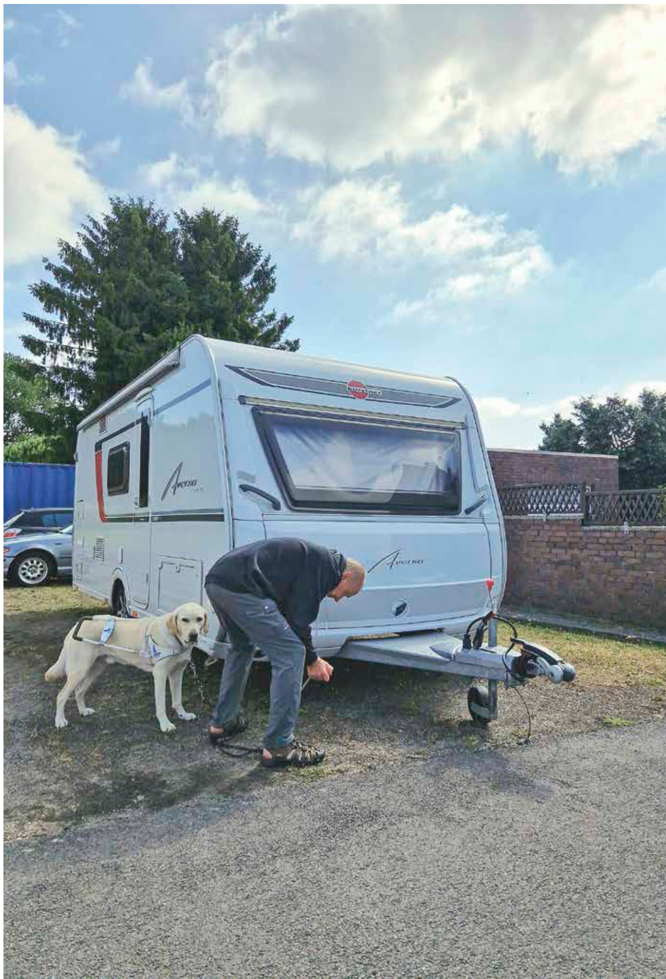
Jotta vaunu saatiin hinauskuntoon, piti siitä monen muun homman lisäksi veivata tukijalat eli tassut ylös. Janne hoitaa veivaamisen ja Patu valvoo työtä.
