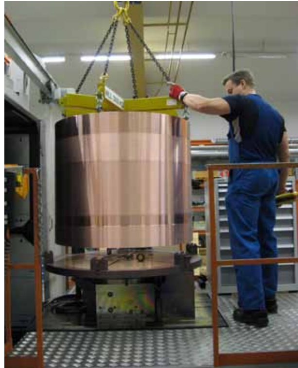
Noin 900 mm pitkän kupariputken asennus EBW-laitteen pyörittäessä. Putken ulkohalkaisija 1050 mm ja seinämä vahvuus 50 mm. Alimmaisena x-y pöytä ja välissä pyörittäessä Kuva: Posiva/Patria.
