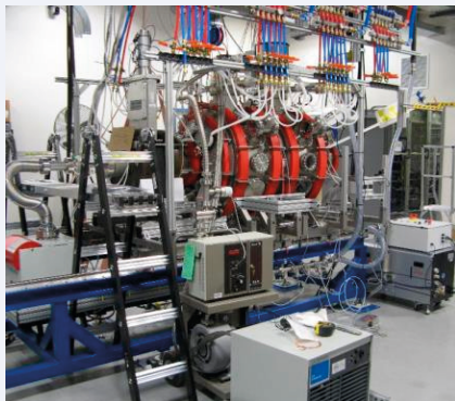
Kuva 4. Lockheed Martinin plasman lämmityskoe T4B, jonka pituus on noin 2 m ja halkaisija 1 m.
