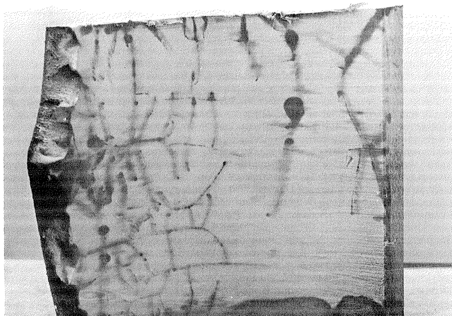
Kylmän ja kuumen veden sekoittumiskohtaan muodostuneita, termisen väsymisen aiheuttamia säröjä tunkeumanesten avulla tarkastettuna.
