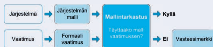
Kuva 1. Mallintarkastuksessa tarkasteltava järjestelmä mallinnetaan, ja järjestelmään liittyvät vaatimukset laaditaan aikalogiikan lausekkeina.
