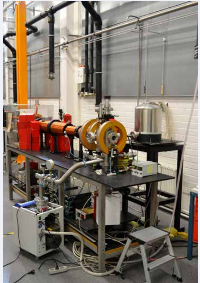
Kuva 2. Doppler-levenemälaitteisto, jossa käytetään hitaita positroneja. Ensin positronit hidastetaan, sitten kiihdytetään haluttuun kineettiseen energiaan ja ohjataan näytteeseen. Positroni annihiloituu näytteessä elektronin kanssa ja tästä tapahtumasta mitataan annihilaatiogammafotonin Doppler-siirtymä. Yhden ilmaisimen tapauksessa vain yksi tapahtuman annihilaatiogammafotoneista voidaan havaita.
