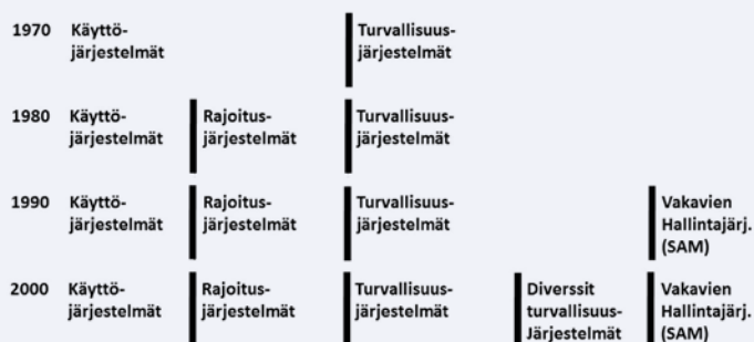
Kuva 1. Ydinlaitosten käyttöön ja turvallisuuteen liittyviä toiminnallisia tasoja (ja samalla erilaisia järjestelmiä) on lisätty suunnilleen kerran vuosikymmenessä vuosina 1970–2000.
