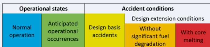
Kuva 2. Laitostilat ja tapahtumakategoriat SSR-2/1 Rev. 1:n mukaan. Viisi tasoa etenevät vasemmalta oikealle ja samalla tapahtumataajuus laskee.
