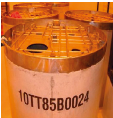
Betoninen käyttämätön loppusijoitusastia.
