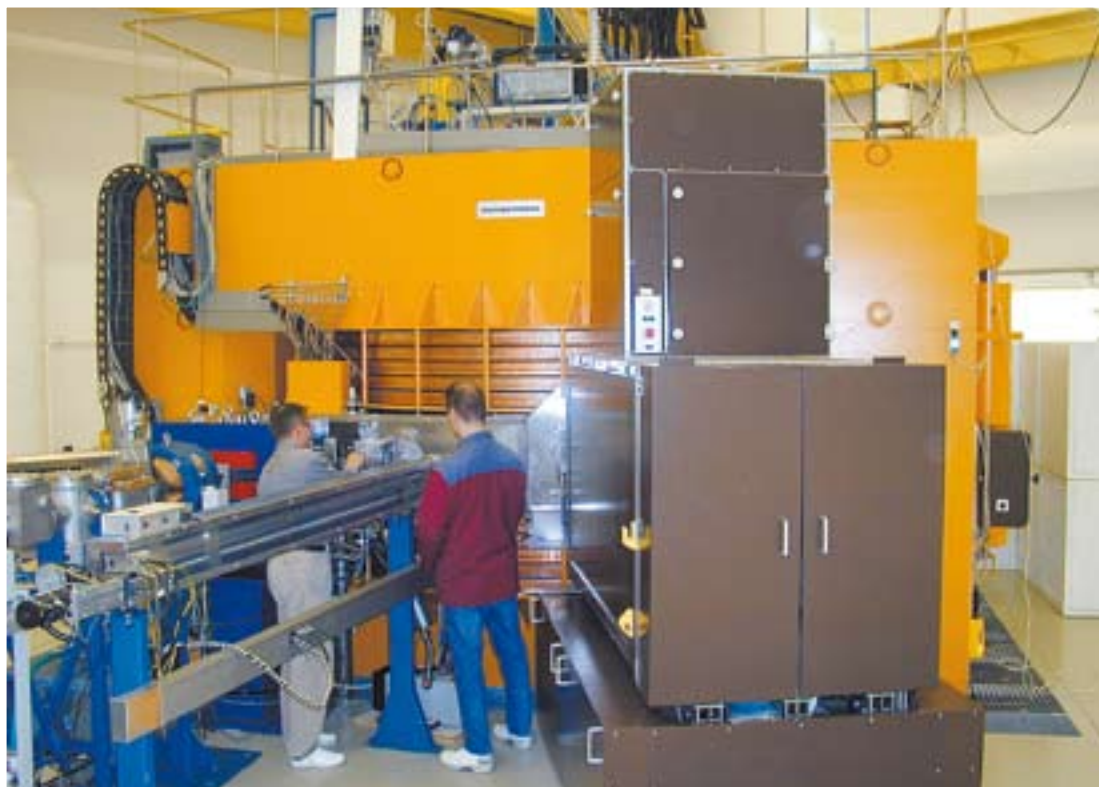
Jyväskylän syklotronista saadaan ECR-ionilähteiden avulla erilaisia ionisuihkuja protoneista ksenoniin. Suihkun maksimienergia E = K(q^2/A) MeV, missä K = 130 , q kiihdytettävän ionin varausaste ja A massaluku.
