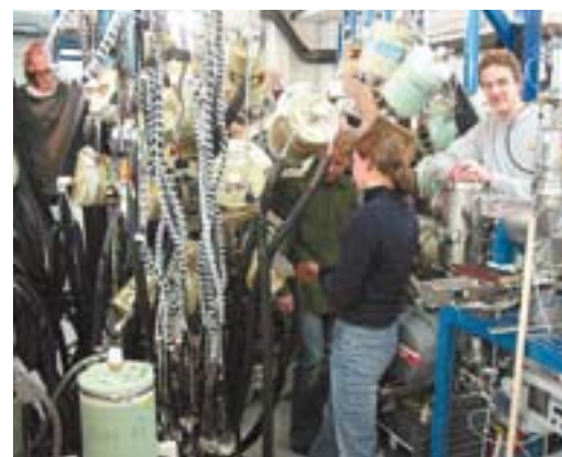
Jyväskylän kiihdytinlaboratoriossa noin puolet tutkimushenkilökunnasta on opiskelijoita. Kuvassa opiskelijajoukko testaa 43 Ge- ja BGO-ilmaisimen muodostamaa ilmaisinpalloa.
