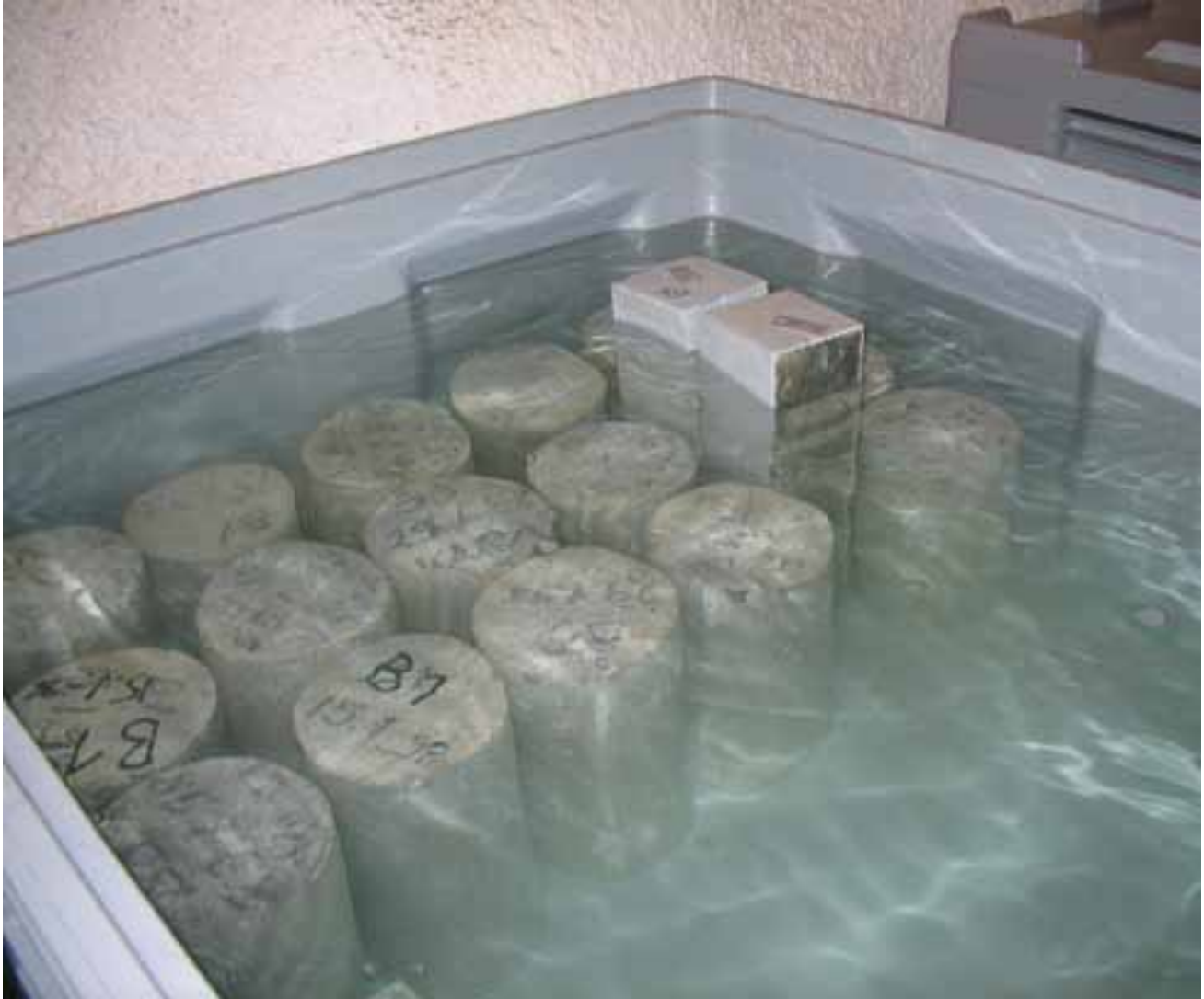
TVO:n ja Fortumin yhteisen tutkimushankkeen betonisia koekappaleita säilytysliuoksessa Olkiluodon VLJ-luolassa (Kuva: Tiia Puukka, TVO)
