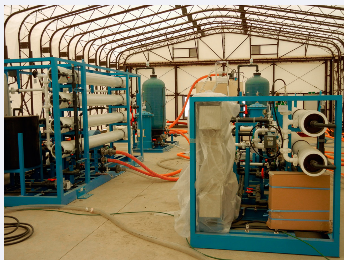
Kuva 2. Ioninvaihtimet sitovat itseensä radioaktiivisia aineita luovuttaen nesteeseen tavallisia suola- ja vetyioneja; ALPS järjestelmällä puhdistetaan suolanpoistolaitteistolta tuleva konsentraatti.
