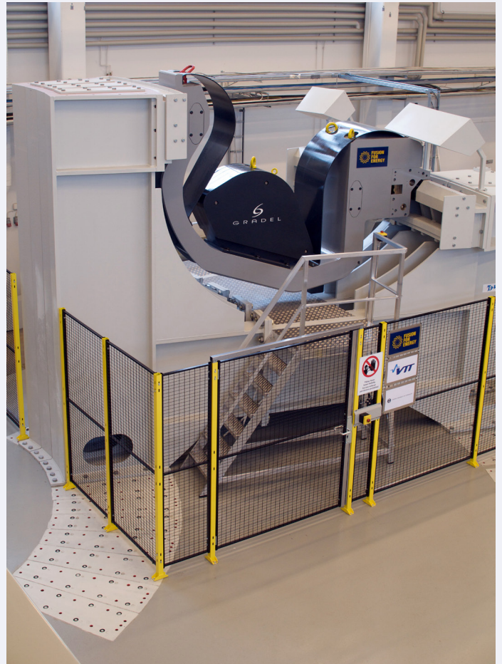
Kuva 3. Noin 9 tonnia painavan divertorikasetin millintarkkaa etäohjausta testataan DTP2-testausjärjestelmässä VTT:n tiloissa Tampereella.
