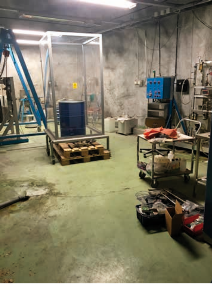
Vanha aktiivisen materiaalin autoklaavitala ennen (vasemmalla) ja jälkeen (oikealla) puhdistuksen. Tilasta poistettiin irtaimisto, minkä jälkeen lattiat märkäpestiin, pesuvesi imuroitiin säiliöön ja mitattiin puhtaaksi. Seinäpinnat mitattiin ja todettiin vapaiksi kontaminaatiosta.
