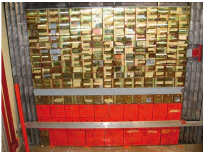
Tutkimusnäytevarasto ja aktivoituneita Charpy V-iskukoesauvoja.
