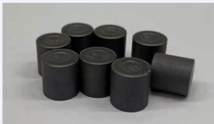
Kuva 1. Luonnonuraanipellettejä, joita ei ole säteilytetty, voidaan käyttää polttoainemateriaalien perustutkimuksessa esimerkiksi mikrorakennetta tai pohjaveteen liukenemistä tutkittaessa.
