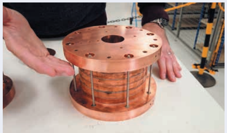
Kuva 2. Vasemmalla ST40-pallotokamak, oikealla ennätysmagneetti: 24,4 teslaa 21 kelvinin lämpötilassa [2] (kuvat: Tokamak Energy).
