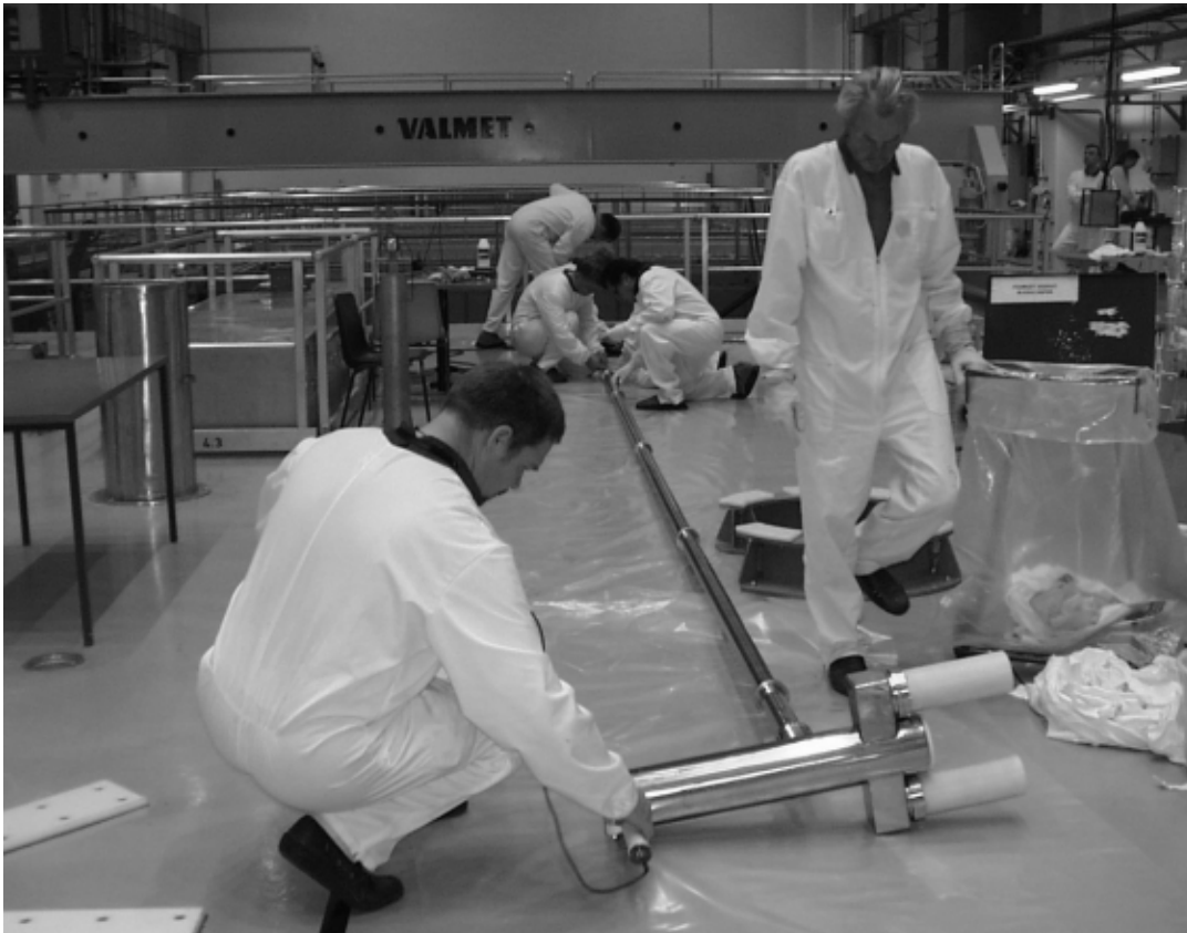
Käytetyn ydinpolttoaineen Fork-mittalaitetta puhdistetaan Olkiluodon kpa-varastolla. Kuva Matti Tarvainen, STUK.
