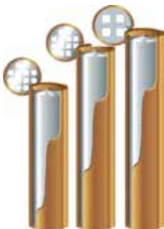
Loppusijoituskapseli Loviisan 1-2 (VVER-440), Olkiluoto 1-2 (BWR) ja Olkiluoto 3 (EPR) reaktorien käytetyille polttoaineelle (vasemmalta oikealle). Kuva: Posiva
