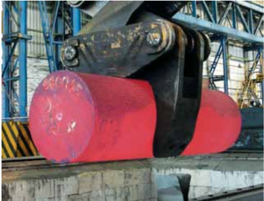
Kuuma kupariaihio, josta kuumamuokkaamalla valmistetaan kuparikapseli.
