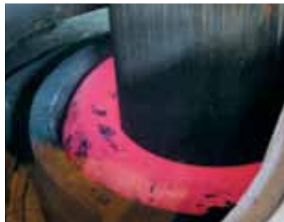
Tyssätyä kupariaihiota painetaan tuurnalla siten, että tuurna ei lävistä koko aihiota, vaan pohjaan jätetään riittävä paksuus kuparia kapselin pohjan valmistamisen mahdollistamiseksi kuumamuokkausprosessin yhteydessä.
