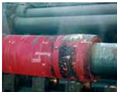
Avonaisen lieriön sisään työnnetään tuurna ja lieriötä työnnetään teräslevyä vasten, jolloin aihion halkaisija kasvaa.
