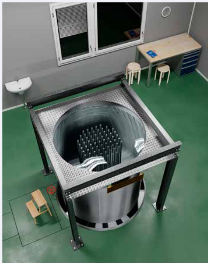
Kuva 2. Havainnekuva miilurakennuksen sisältä. Kuvasta on jätetty selvyuden vuoksi pois reaktoritankin yläpuolelle sijoitetut tukirakenteet, joita käytettiin polttoainesauvojen ripustukseen. Värimaailman ja pintamateriaalien osalta visualisoinnissa on käytetty mielikuvitusta. Miilurakennuksen sisältä on vain muutama mustavalkoinen valokuva.
