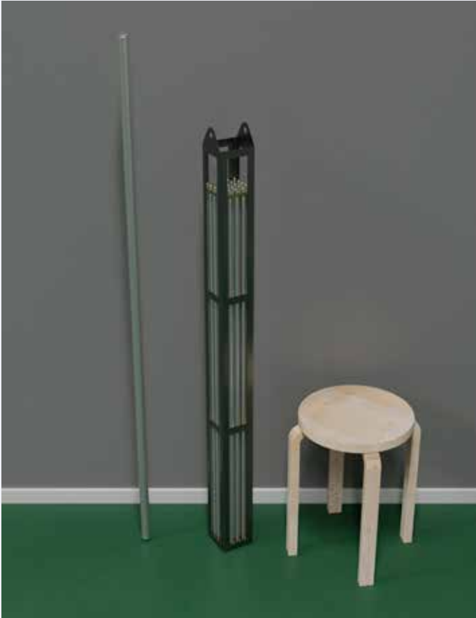
Kuva 4. Havainnekuva miilun polttoaineesta. Vasemmalla vanhantyyppinen polttoainesauva, joka koostui alumiiniputken sisälle kapseloidusta tuuman paksuisista uraanitangoista. Oikealla uuden sydämen polttoaine-elementti, joka oli kasattu 25 ohuemmasta polttoainesauvasta.
