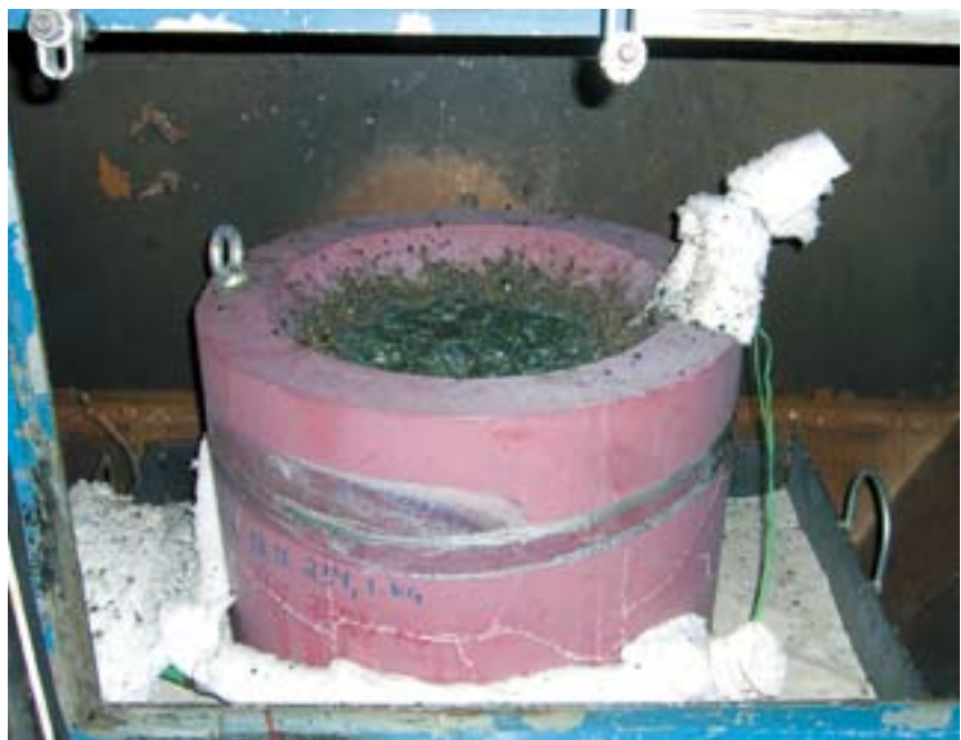
HECLA-4 -kokeen lopputila. Teräs on jähmettynyt betoniastiaan.
