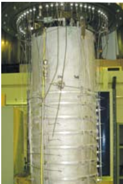
STYX -koelaitteiston sisäsylinteri asennustöiden aikana. Partikkelikeko on sylinterin sisällä.
