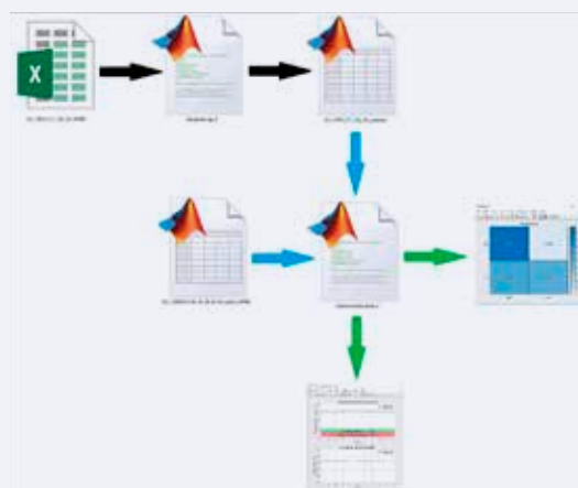
Kuva 4. Havainnollistava prosessikaavio mittausdatan käsittelyketjusta. Samanväriset nuolet kuvaavat samanlaisen rakenteen omaavaa dataa. Koneoppimisen tuloksia voi havainnollistaa esimerkiksi sekaannusmatriisilla (oikealla) tai reaaliaikaisella piirturilla (alhaalla).
