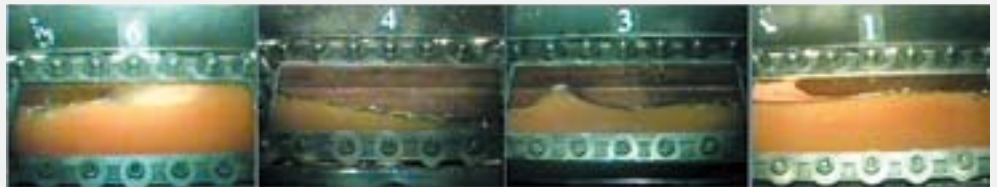
Kerrostunut (yläkuva) ja aaltomainen (alakuva) virtaus VOLLEY-koelaitteiston jäähdytyskanavassa, virtaussuunta vasemmalle. EPR:n sydänsulan levitysalueen jäähdytysjärjestelmän kokeita.
