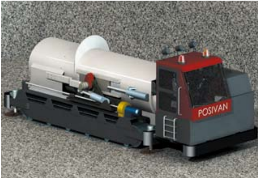
Loppusijoituskapselin kuljetus- ja asennusajoneuvo. Tela-alustaisella ajoneuvolla kapselia siirretään säteilysuojan sisällä loppusijoitus-tiloissa sekä asennetaan loppusijoitusreikään.
