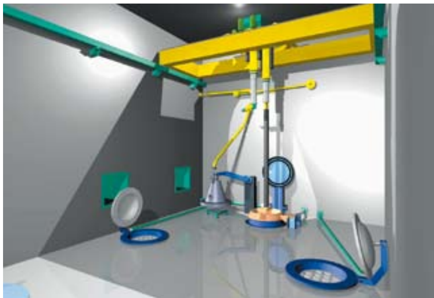
Polttoaineen käsittelykammio. Etualalla polttoaineen kuivausasemat (2 kpl) ja taaempänä loppusijoituskapselin telakointiasema kaasunvaihtokupuineen sekä polttoaineen siirtokone.
