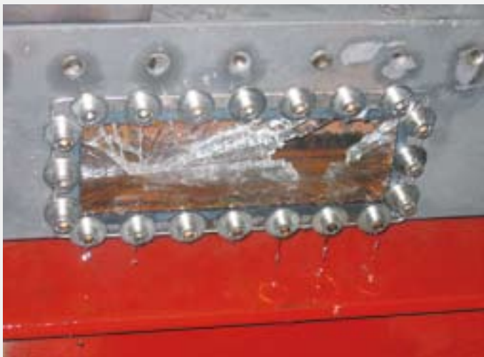
Odottamattomia ilmiöitä: vesi-iskun voimasta särkynyt ikkuna VOLLEY-kokeessa.
