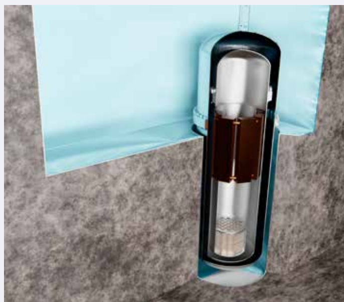
Kuva 2. Lämpönieluna toimivaan vesialtaaseen sijoitettu LDR-50-reaktorimoduuli muodostuu sisemmästä reaktoriastiasta ja ulommasta suoja-astiasta. Poikkileikkauskuvaan on piirretty myös reaktorin sydän sekä lämmönvaihtimet. Primääri- ja sekundääripiirin putkistot sekä muita komponentteja on selkeyden vuoksi jätetty kuvasta pois.
