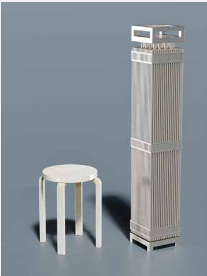
Kuva 1. LDR-50-reaktorin sydän muodostuu metrin mittaisiksi lyhennetyistä 17x17 -tyyppisistä painevesireaktorin polttoainepiipista. Sydämeen ladataan yhteensä 37 nippua.
