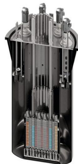
SEALER (Swedish Advanced Lead Reactor) on lyijyjäähdytteinen ydinpatteri (kuva: LeadCold).
