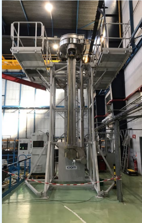
Kuva 3. UGXR-laitteisto. Vasemmalla vedenalainen mittapenkki asennettuna testustorniin. Oikealla gamma- ja röntgenmittauksissa tarvittava kollimaattorijärjestelmä, joka asennetaan reaktorialtaan seinässä olevaan läpiviintiin.
