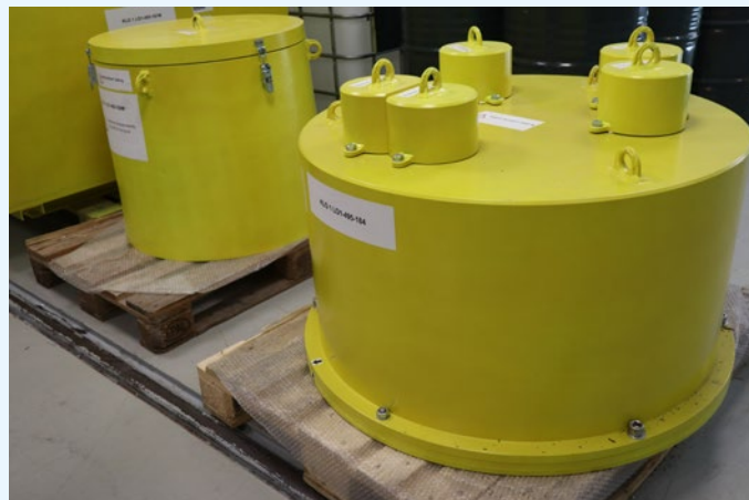
Kuva 1. Käytöstäpoistettujen aktiivisimpien komponenttien säteilysuojat (kuva: Emma Elimäki, Fortum).
