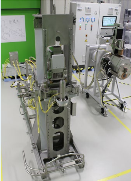
Kuva 2. HGXR-laitteisto. Mittapenkki, johon yksittäinen polttoainesauva kiinnitetään, on vasemmalla. Oikealla on gamma- ja röntgenmittauksiin käytettävä kollimaattorijärjestelmä. Takana näkyvät laitteiston ohjaukseen tarvittavat elektroniikkapaarit.
