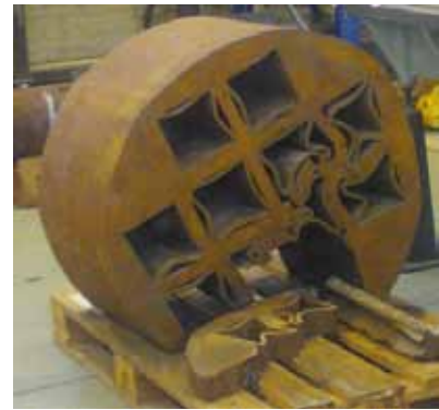
Käytetyn polttoaineen varastoisäiliön osa iso-staattisen puristus-testin jälkeen.
