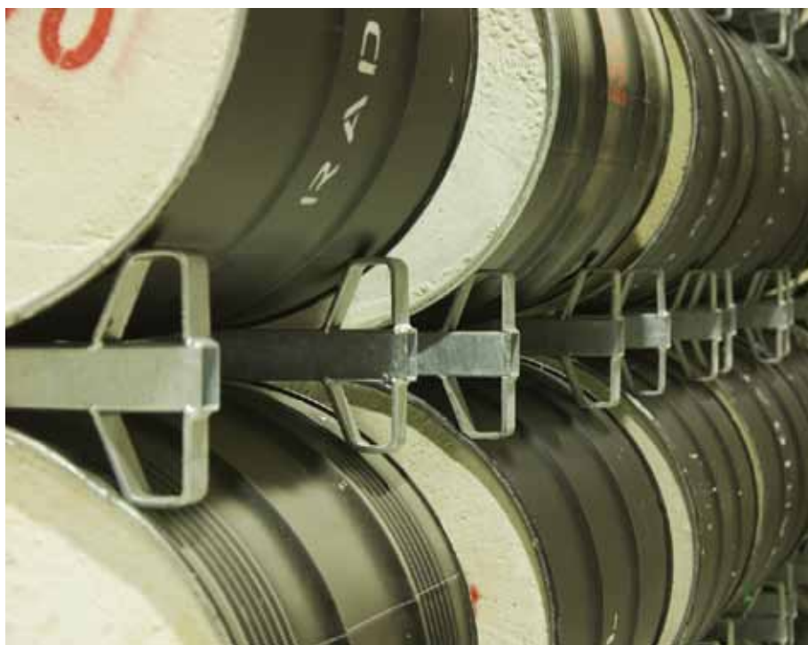
Jätetyynyreitä matala- ja keskiaktiivisen jätteen varastossa LOGissa. Kuva: Covra.
