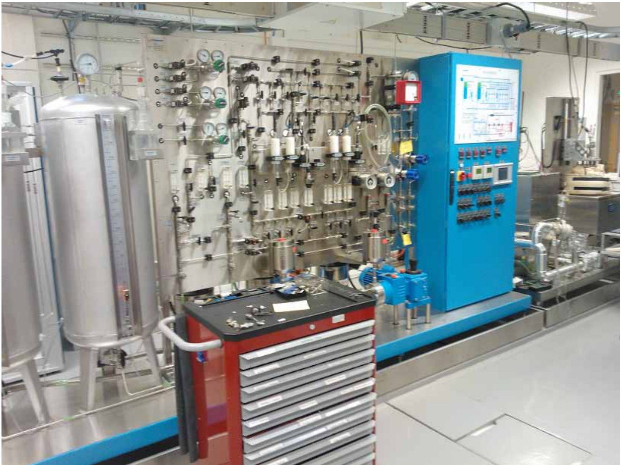
Suomalaista autoklaavilaitteisto-designia IET:n laboratoriossa. Autoklaavilaitteiston avulla tutkitaan vesikemian vaikutusta materiaalien jännityskorroosioon.
