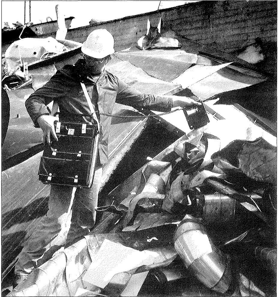
Metalliseoksen tunnistaminen kannettavalla radionuklidiherätteisellä röntgenfluoresenssiin perustuvalla mittalaitteella. Laitte antaa mittaustuloksena suoraan metalliseoksen nimen, joten sen käyttäminen ei vaadi erityistä koulutusta.
