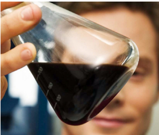
Fortum Otso -bioöljyä valmistetaan puuperäisestä raaka-aineesta nopeapyrolyysiprosessin avulla. Sitä voidaan käyttää esimerkiksi lämpölaitoksilla ja teollisuus-höyryn tuotannossa korvaamaan raskasta tai kevyttä polttoöljyä. Tulevaisuudessa bioöljy voi toimia myös raaka-aineena erilaisille biokemikaaleille tai liikenteen polttoaineille. Kuva: Fortum.
