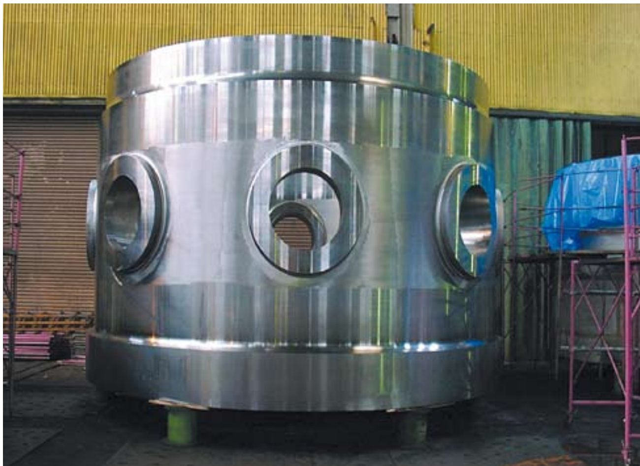
Olkiluoto 3-paineastian yhdekappale Futamin konepajalla v. 2005. (Kuva:TVO)
