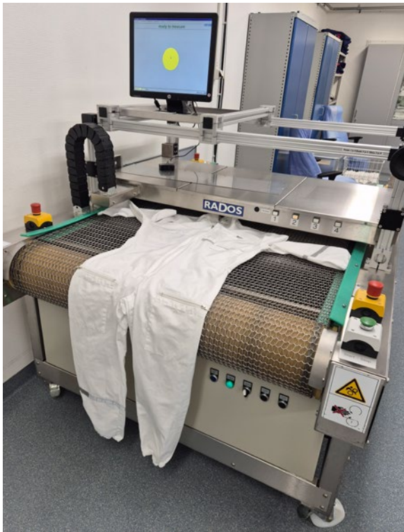
Pyykkimonitori kuljettaa mitattavat vaatekappaleet liukuhihnalla detektorin ohi ja suorittaa mittauksen automaattisesti. Pyykkimonitorin käyttö tehostaa puhtaaksi mittausta huomattavasti verrattuna käsimittariin.
