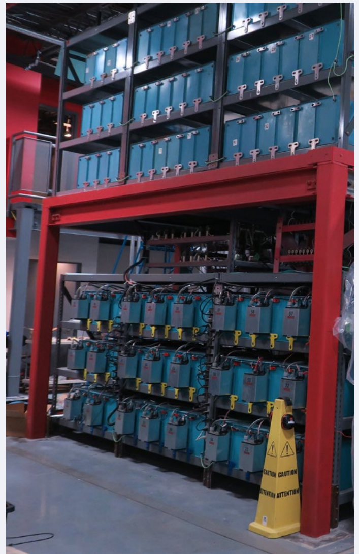
Kuva 9. Osa General Fusionin kondensaattoripankeista (kuva: Tomas Lindén)
