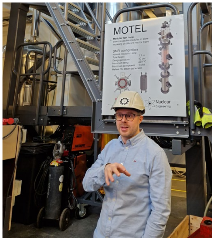
Joonas Telkkä esittelemässä MOTEL-koelaitteistoa, jonka pääparametrit ovat korkeus 7,7 m, suunnittelpaine 40 bar, maksimi lämpötila 250 °C ja sydämen maksimiteho 1 MW (kuva: Eija Karita Puska).
