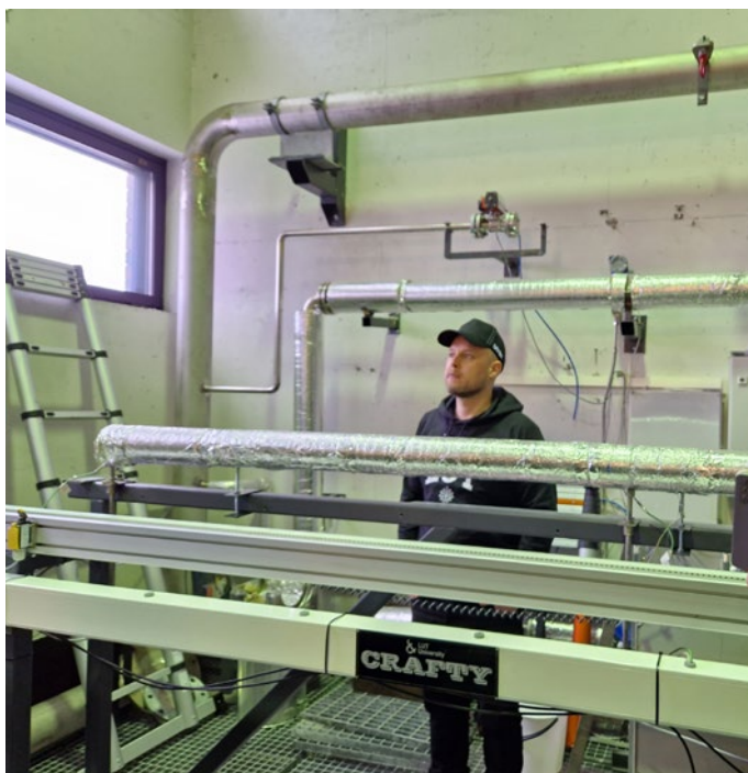
Lauri Pyy esittelemässä CRAFTY-koelaitteiston 'pihviä', eli tiheästi instrumentoitua mittausosaa. Instrumentointi kätkeytyy suojauksen alle, eli aina kuva ei kerro niitä kuuluisaa tuhatta sanaa (kuva: Eija Karita Puska).
