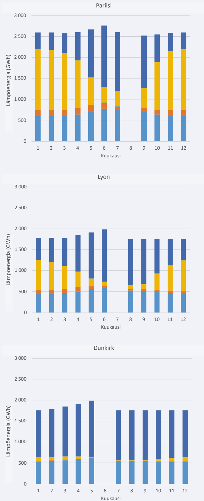
Kuva 2. Kuukausittainen sähkön ja lämmön (korkea-, väli- ja matalapainehöyry) tuotanto kullekin laitokselle.
