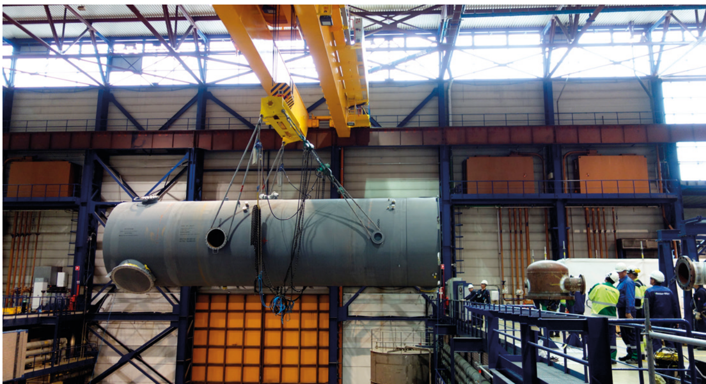
Yhden välitulistimen pituus on 13 metriä ja halkaisija 3,5 metriä. Painoa välitulistimella on yli 90 tonnia.
