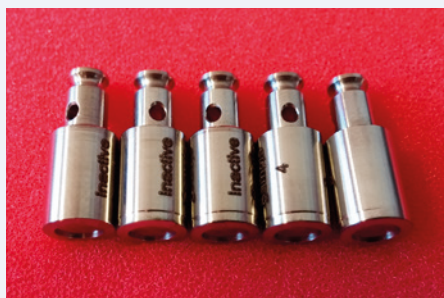
Kuva 1. Tyypillisiä "dummy"-umpilähdekapselaita. Kuvan kapselit eivät sisällä radioaktiivista ainetta.
