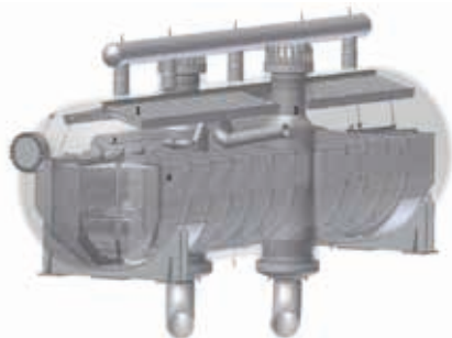
Loviisan voimalaitoksessa on molemmilla yksiköillä 6 vaakahöyrystintä, joiden tehtävä on siirtää reaktorin tuottama energia sekundääripiiriin.
