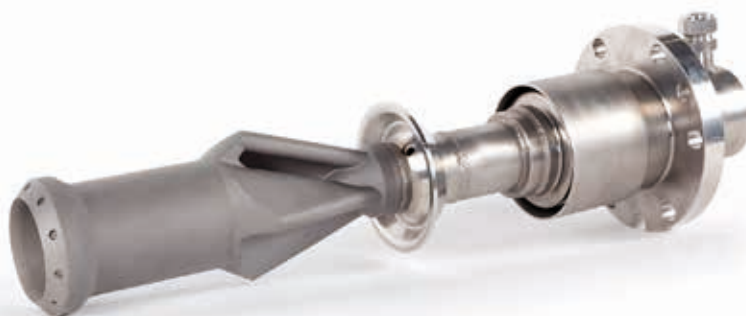
Siemensen jauhepetisulatustekniikalla (L-PBF) valmistama kaasuturbiinipoltin koostuu vain yhdestä osasta eikä hitsausliitoksia tarvita. Siirryttäessä lisäävän valmistuksen käyttöön komponentin läpimenoaika lyheni merkittävästi (kuva: Siemens Energy).
