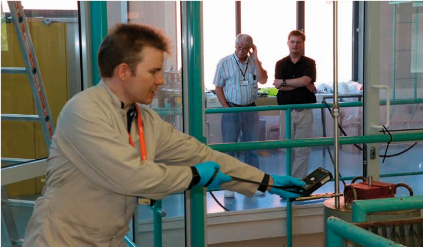
VTT:n Antti Rätty mittaamassa annosnopeuksia tutkimusreaktorin polttoaine-elementin lyhennetyistä instrumentaatioputkesta Idaho National Laboratoryn teknikoiden seurattessa operaatiota.
