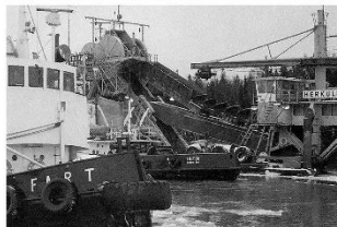
Kansiproomu Oskar rakennettiin Asemetsä Oyn omaan käyttöön ja se valmistui vuonna 1990 lohkovä- ja kuljetusastaksi suurlohkoille. Vuosina 1990-91 toteutettiin Merivoimien öljyntorjunta-alus Hylyksen muutostyöt. Alusta jatkettiin 4,2 metriä ja uusiin kansivarustus. Hylyte varusteltiin öljyntorjuntalaitteistolla ja sukellusmälävalaiteistolla. Siihen asennettiin kaksi Aquamaster-potkurilaitetta, jotka sopeutettiin konehuonejärjestelyihin.
