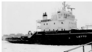
Merenkulkuhallituksen väylähoitoalus Letto muutettiin montitoimialukseksi varustamalla se mm. öljyntorjuntalaitteistolla. Muutostyöt valmistui maaliskuussa vuonna 1997.
