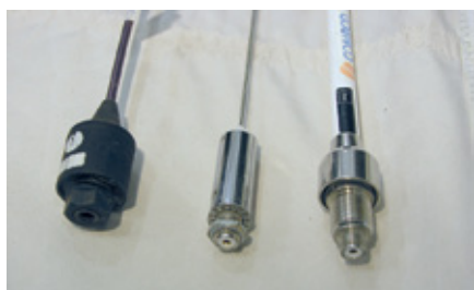
2.37. Vasemmalla oleva antenni on ns. eristetty antenni, muut eristämättömiä.
