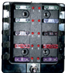
5.26. Tyypillinen pienen veneen kymmenellä lattasulakkeella varustettu sulakerasia.
