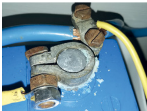
2.15. Hapettunut ja murtunut akkukengä.
