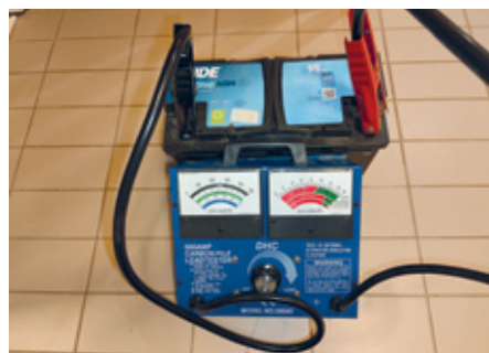
2.22. Testattavaan akkuun kytketty 500 A Hiilipakkatesteri (Carbon pile load tester).
