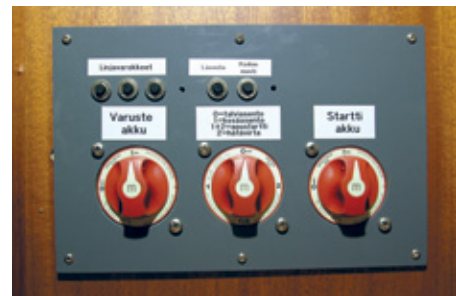
2.34. Veneen pääkytkinjärjestelmä: Moottorin pääkytkin on 2-napainen, jolloin se katkaisee plus- ja miinusvirran koneelta. Keskimäinen kytkin on pysyvän virran pääkytkin, jossa lisäksi hätäkäynnistys toiminto.
