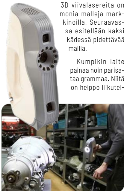
Tässä kuvassa on Artec Eva ja vaihdelaatikon kuvaus käynnissä.
