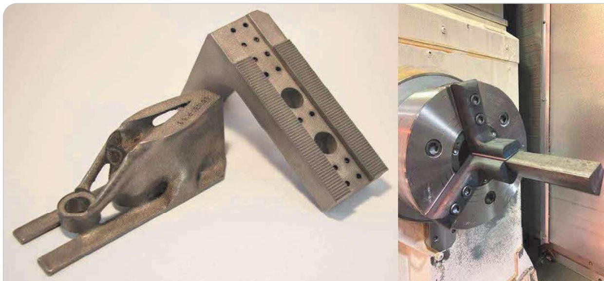
3D-tulostetuilla koneistuskiinnittimillä on merkittävä vaikutus uuden tuotteen valmistuksen ylösajamiseen.
