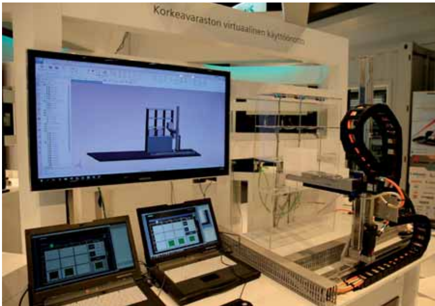
Heinon ja Vapalahden rakentama digitaalinen kaksonen pitää sisällään simuloidun työympäristön, jossa järjestelmää voidaan hallita tehokkaasti ilman vaaratekijöitä.
