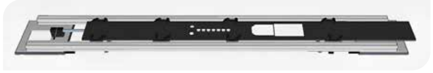
Paletti kiinnikkeet, joita käytettiin COP-etulevyjen turvalliseen siirtämiseen asemien välillä. Tähän konseptiin valittiin Bosch Rexroth TS2 -modulaarinen kokoonpanokuljetin (saatavana Visual Componentsin eCatalogista), joka pystyi kuljettamaan näitä kuormalavoja asemien välillä.
